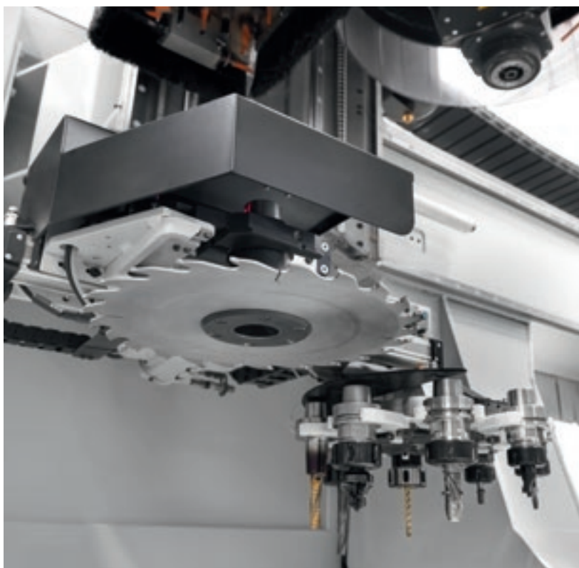
Одноместный магазин и Инструментальный магазин револьверного типа на 8 мест.
