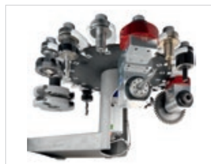
Инструментальный магазин револьверного типа на 16 мест
